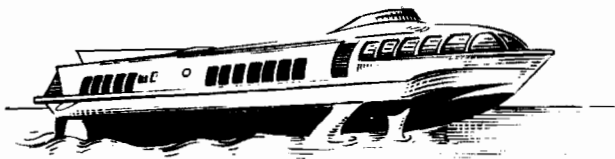
Рис. 1.12. Пассажирское судно на подводных крыльях «Метеор» на 150 пассажиров. (1960 г.). Скорость 80 км/час
